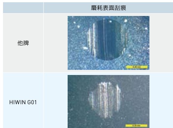
在不同潤滑脂潤滑情況下之鋼球磨耗金相圖
